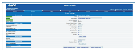
Abb.: Im komfortablen Webinterface können alle an der sensorProbe8 angeschlossenen intelligenten Sensoren samt der erforderlichen Alarmarten individuell konfiguriert werden. Mit dem kostenlosen probeManager können Sie alle im Netz vorhandenen AKCP AlarmServer zentral verwalten.
